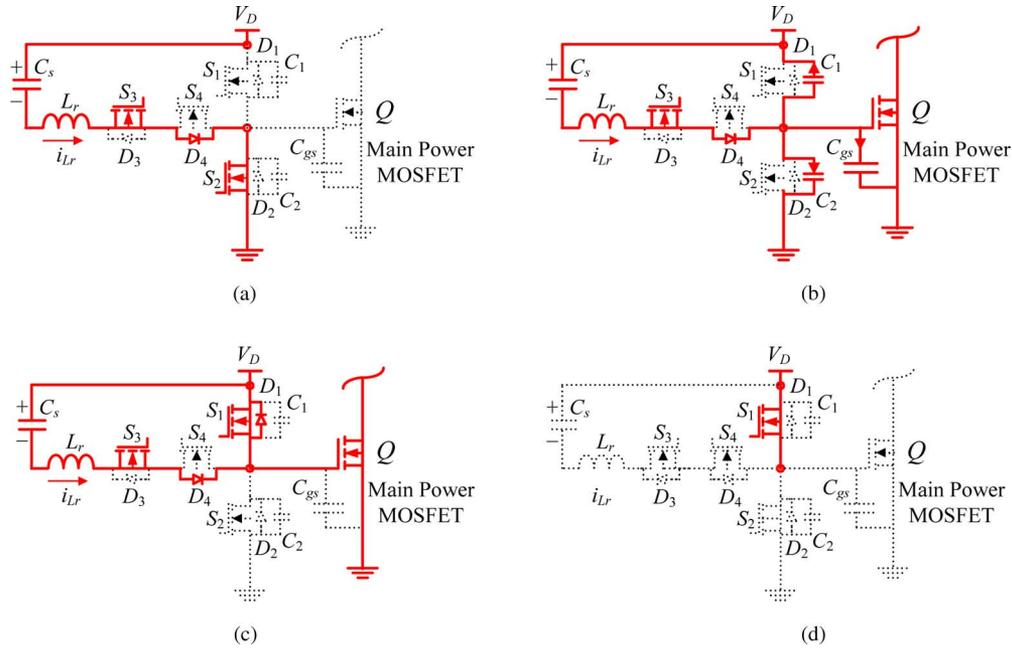
Fig. 3. Equivalent circuits: turn ON intervals. (a)  $[t_4, t_5]$ . (b)  $[t_5, t_6]$ . (c)  $[t_6, t_7]$ . (d)  $[t_7, t_8]$ .
