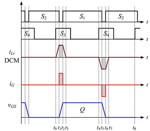
Fig. 2. Key waveforms of the proposed CSD. (a)  $[t_0, t_1]$ . (b)  $[t_1, t_2]$ . (c)  $[t_2, t_3]$ . (d)  $[t_3, t_4]$ .
