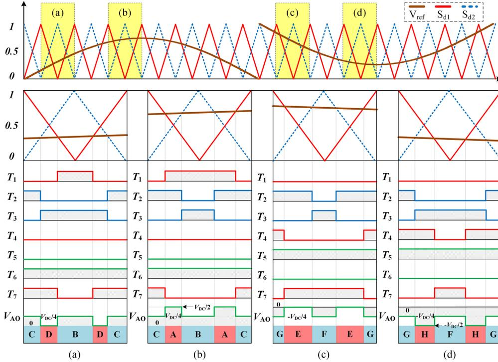
Fig. 13. ASFD PWM for 7S-5L-ANPC inverter. (a)  $0 < V_{ref} < 0.5$ . (b)  $V_{ref} > 0.5$ . (c)  $-0.5 < V_{ref} < 0$ . (d)  $V_{ref} < -0.5$ .
