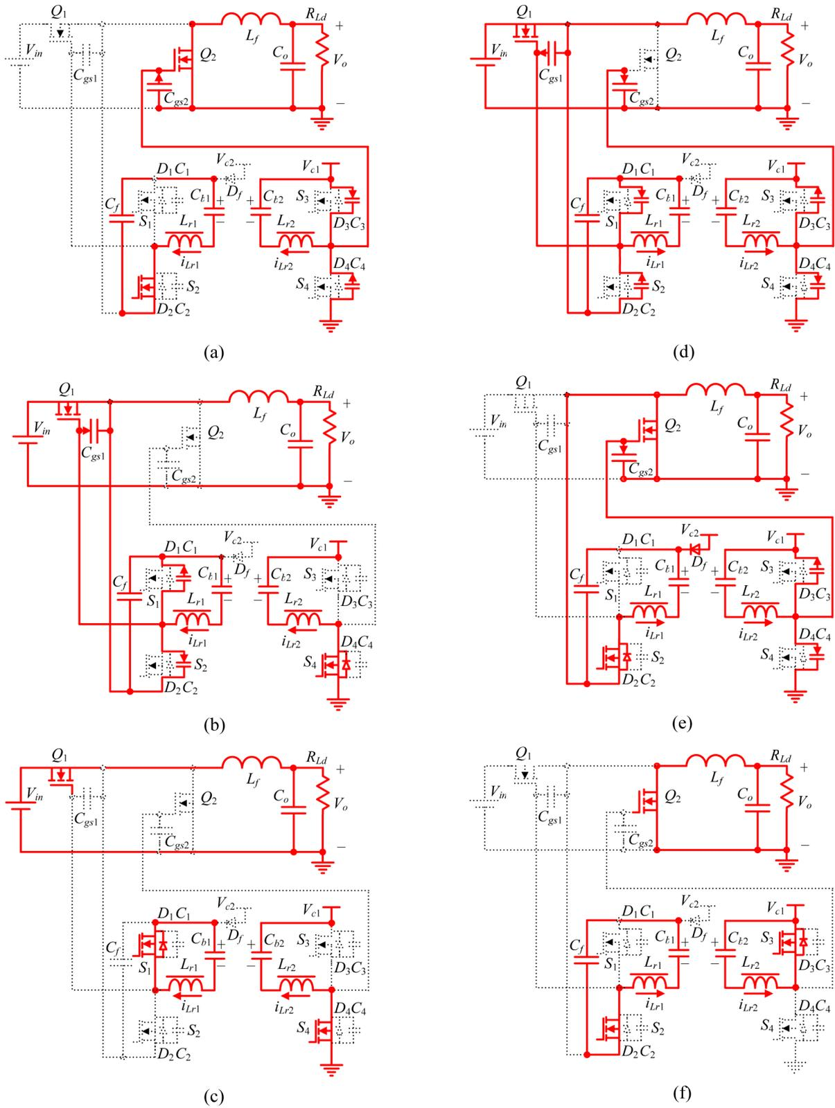
Fig. 5. Equivalent circuits of operation. (a)  $[t_0, t_1]$ . (b)  $[t_1, t_2]$ . (c)  $[t_2, t_3]$ . (d)  $[t_3, t_4]$ . (e)  $[t_4, t_5]$ . (f)  $[t_5, t_6]$ .
