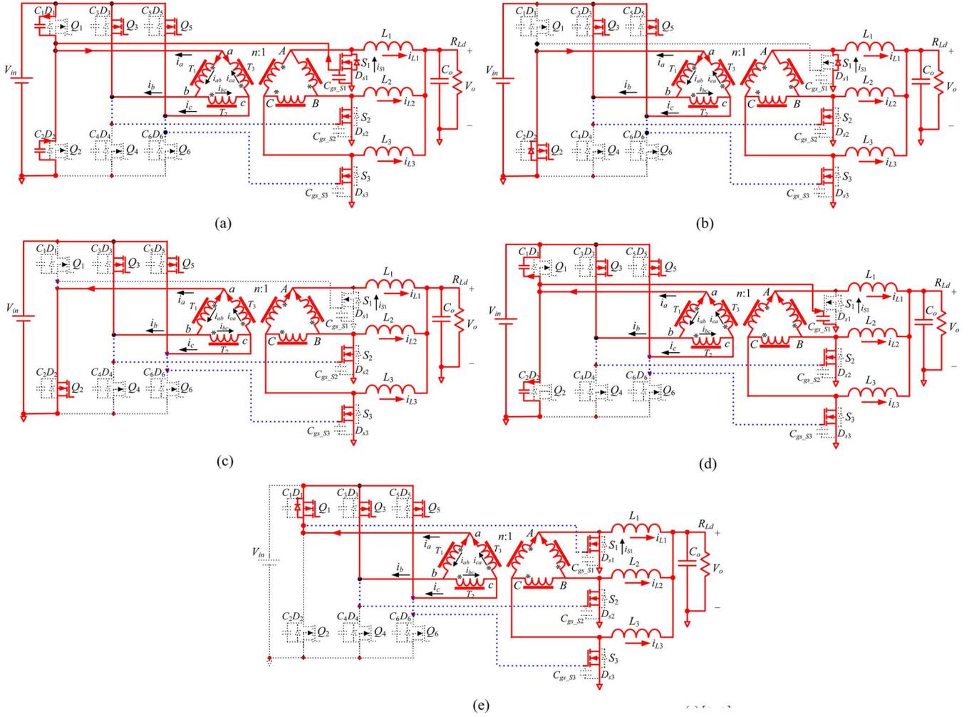
Fig. 3. Equivalent circuits of operation. (a)  $[t_0, t_1]$ . (b)  $[t_1, t_2]$ . (c)  $[t_2, t_3]$ . (d)  $[t_3, t_4]$ . (e)  $[t_4, t_5]$ .
