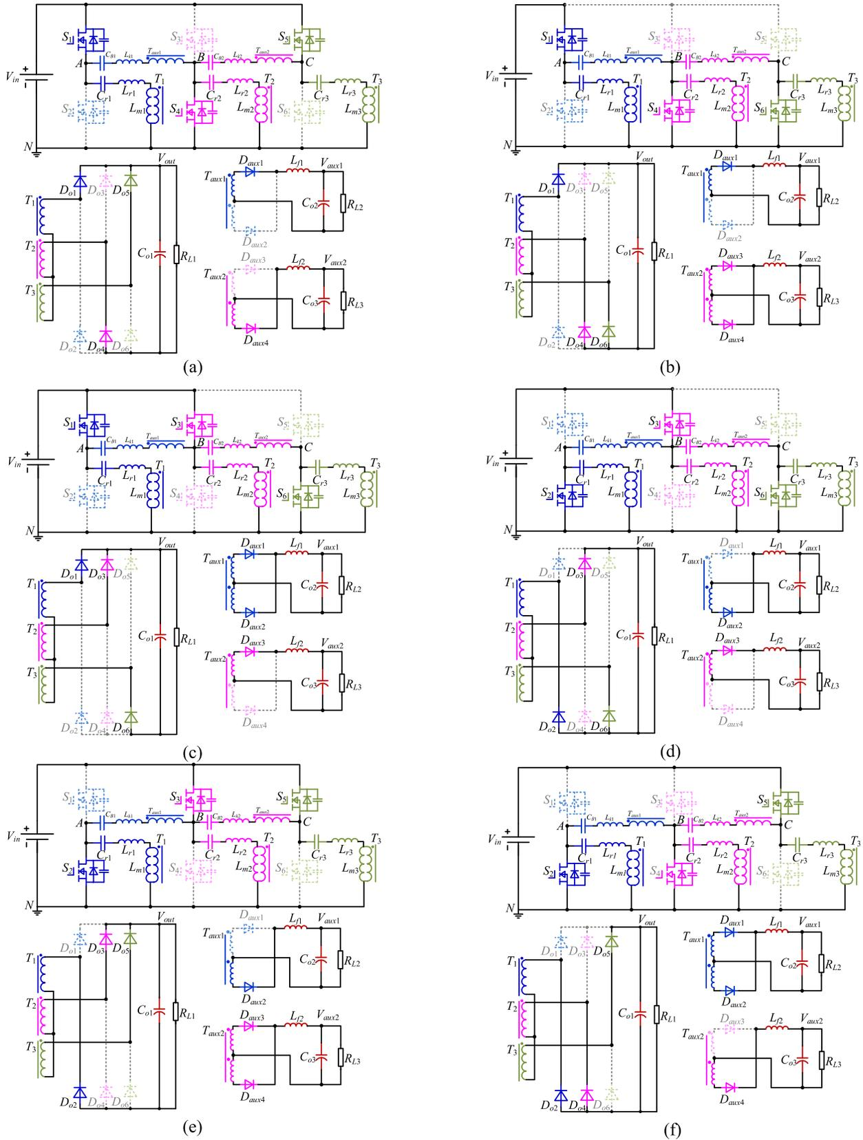
Fig. 3. Operational modes of the proposed converter. (a) Interval 1 ( $t_0 \leq t < t_1$ ). (b) Interval 2 ( $t_1 \leq t < t_2$ ). (c) Interval 3 ( $t_2 \leq t < t_3$ ). (d) Interval 4 ( $t_3 \leq t < t_4$ ). (e) Interval 5 ( $t_4 \leq t < t_5$ ). (f) Interval 6 ( $t_5 \leq t \leq t_6$ ).
