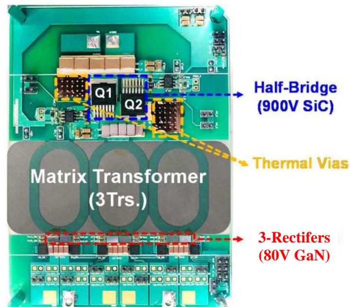
Fig. 11. LLC DCX Converter Prototype 450W/in<sup>3</sup>
